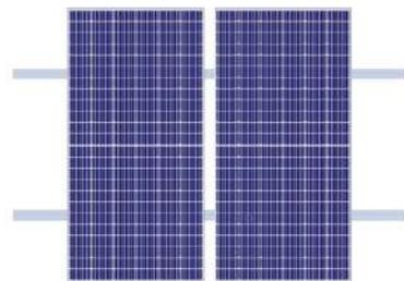
Colocar los paneles de forma que sobre la misma cantidad de perfil coplanar por cada lado.
